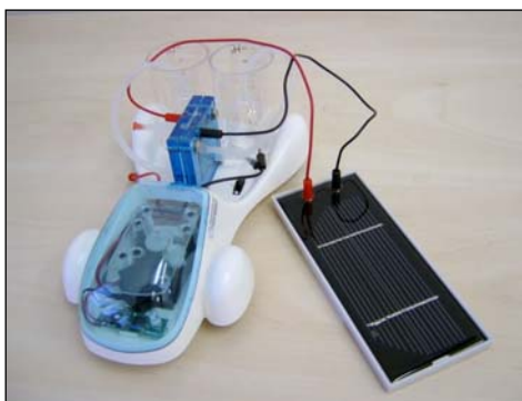
10.18., 10.19, 10.20. ábra: Tüzelőanyag cellás modellek (Modellre szerelt napelemmel; Modellhez kapcsolható napelemmel; Hidrogén-oxigén kutat működtető napelemmel; A napelemek a vízbontás energiáját fedezik.)
