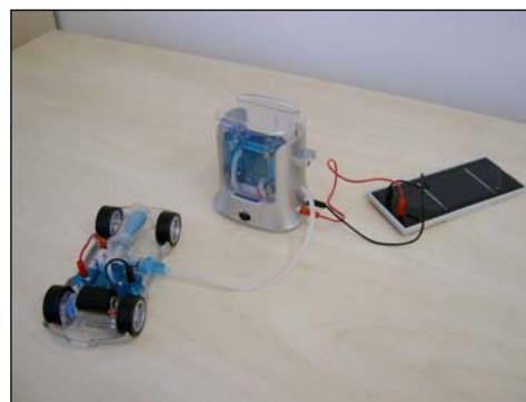
10.18., 10.19, 10.20. ábra: Tüzelőanyag cellás modellek (Modellre szerelt napelemmel; Modellhez kapcsolható napelemmel; Hidrogén-oxigén kutat működtető napelemmel; A napelemek a vízbontás energiáját fedezik.)
