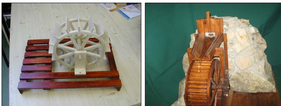
9.6. kép: Felülsapott és alulcsapott vízkerék modellje
