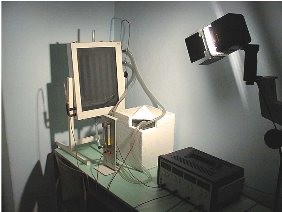
9.3. kép: Síkkollektor modell mérőeszközökkel
